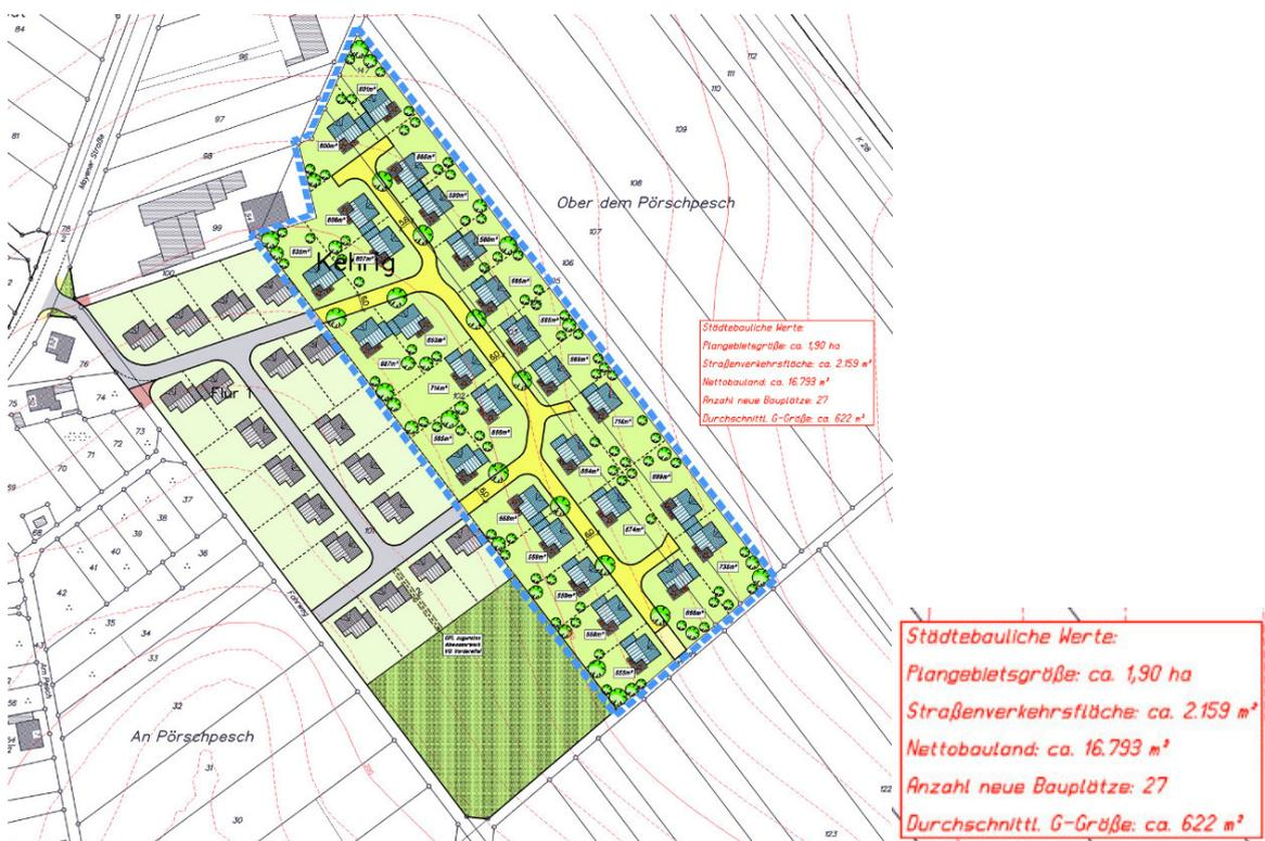
Abb: Städtebaulicher Gestaltungsentwurf einschließlich der Kennwerte
