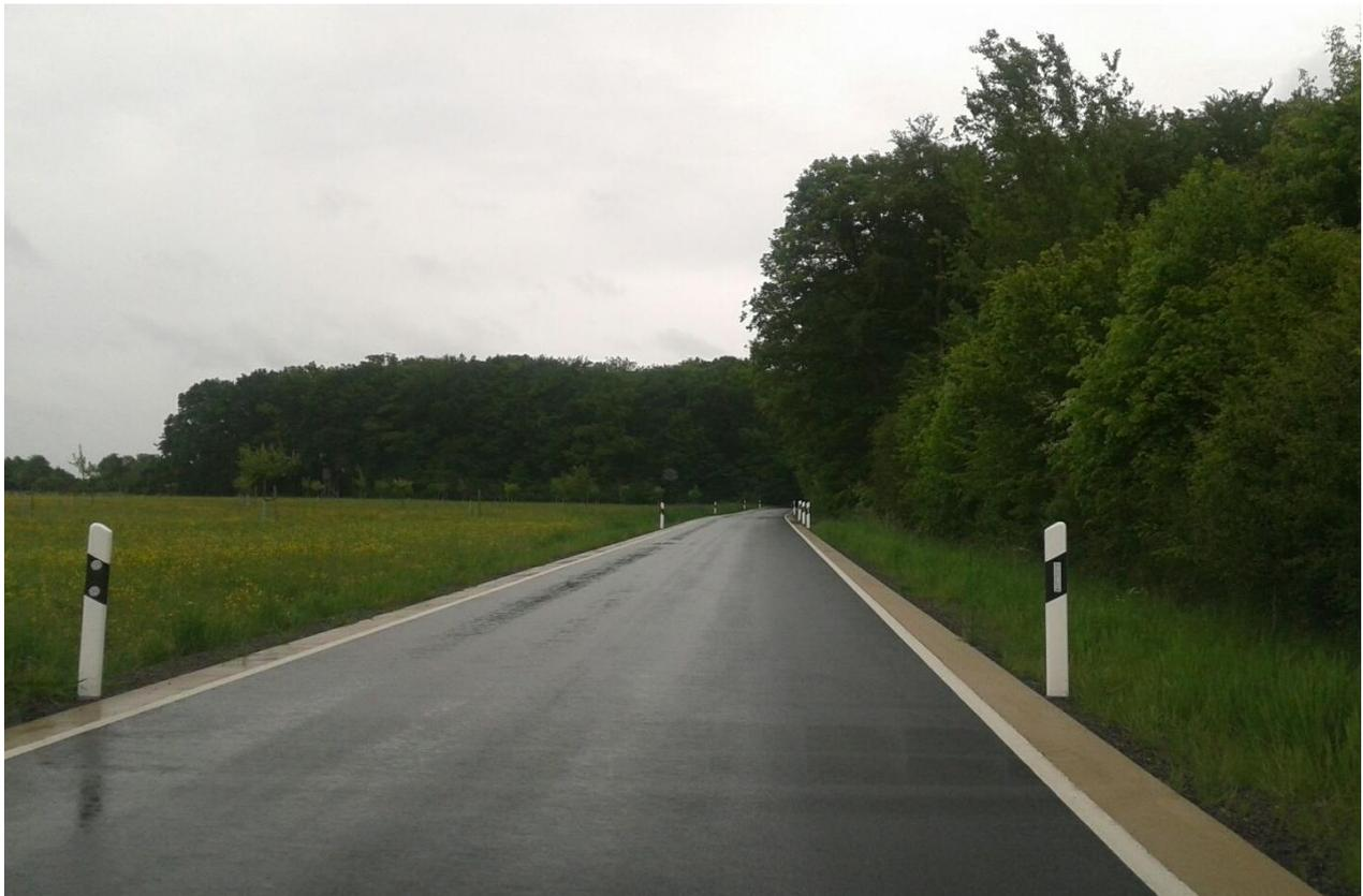
Beidseitig Randbalken in Betonbauweise; Herstellung mittels Gleitschalungsfertiger
