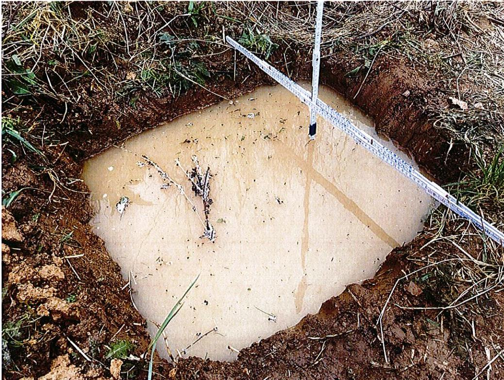
Bild 2: Schürfgrube mit Wasser befüllt
