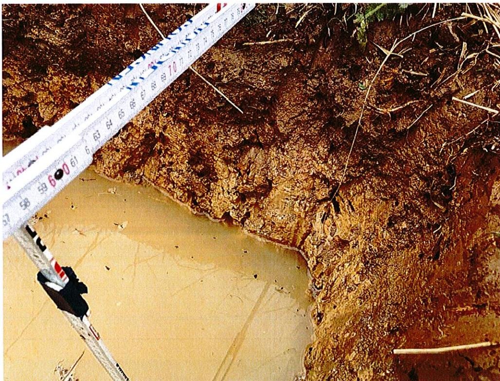
Bild 3: Schürfgrube während der Versickerung (Klüfte erkennbar)
