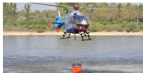
Abb. 1: Polizeihubschrauber mit Bambi-Bucket bei der Wasseraufnahme
