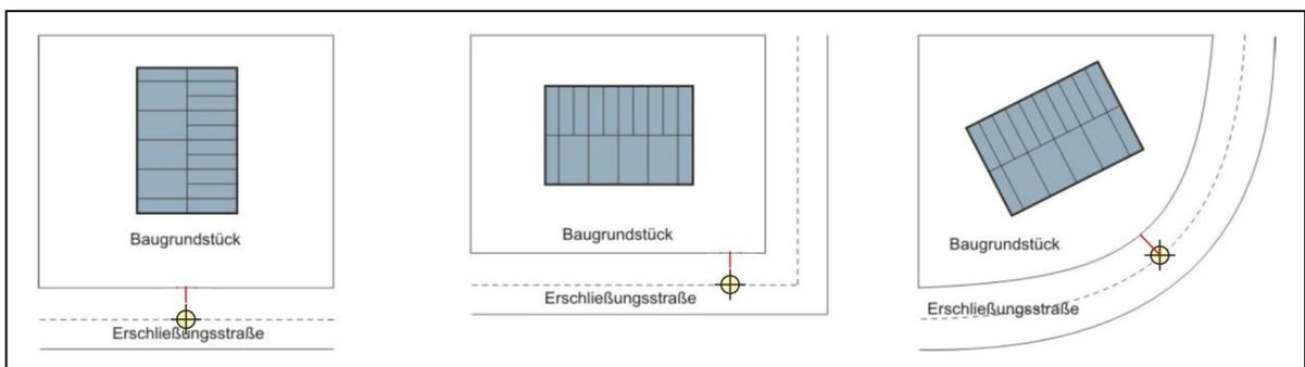
**Abb. 6: Prinzipskizze maßgebender unterer Bezugspunkt**
