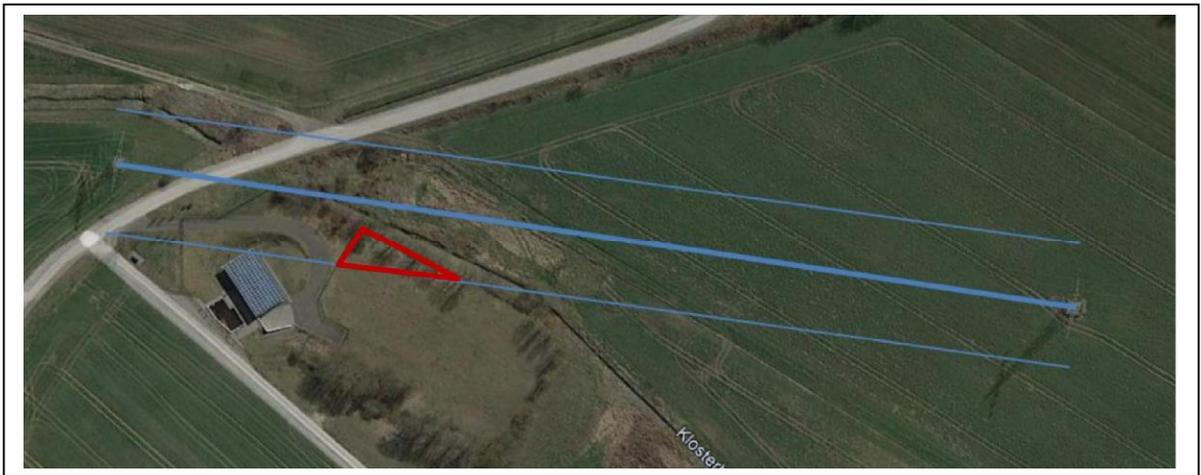
Abb.7: Leitungsführung Hochspannungsfreileitung mit Schutzstreifen – rot = Überschneidung Plangebiet (Ing.-Ges. Tutas Meyer – unmaßstäblich)
